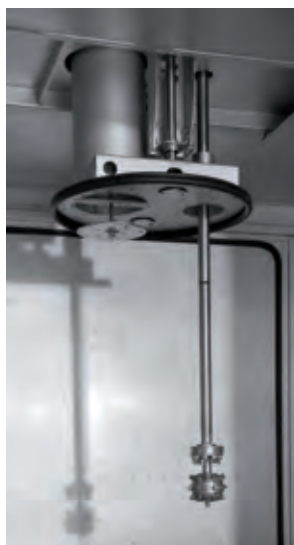
Unidad de limpieza interior Con tubería móvil vertical
