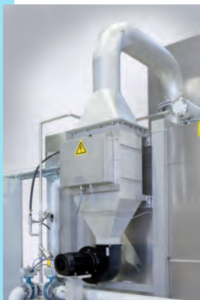
Secado integrado Circulación de aire caliente.
