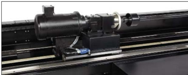
La nueva HTA es una máquina eléctrica. Al no tener hidráulica, genera menos ruido, sin fugas, mejor control y mayor precisión en los puntos de inversión del carro.
