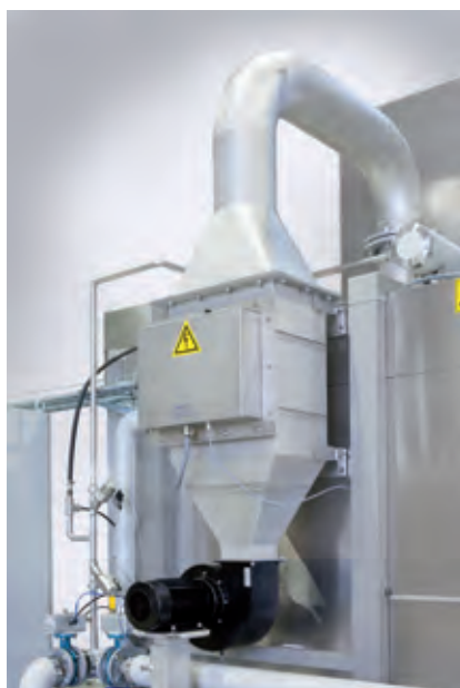
Secado integrado Circulación de aire caliente.
